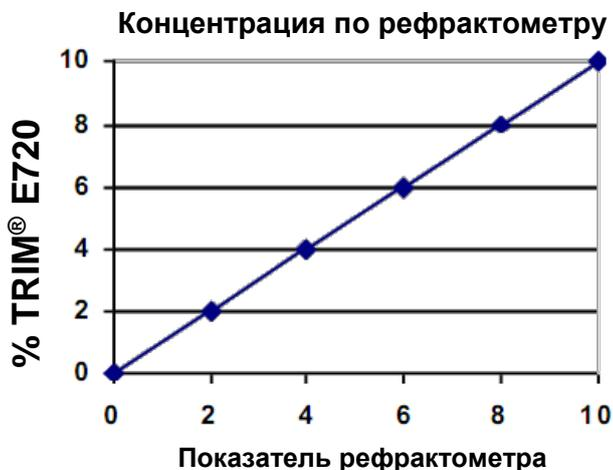
% концентрации = Значение рефрактометра x коэффициент рефрактометра
